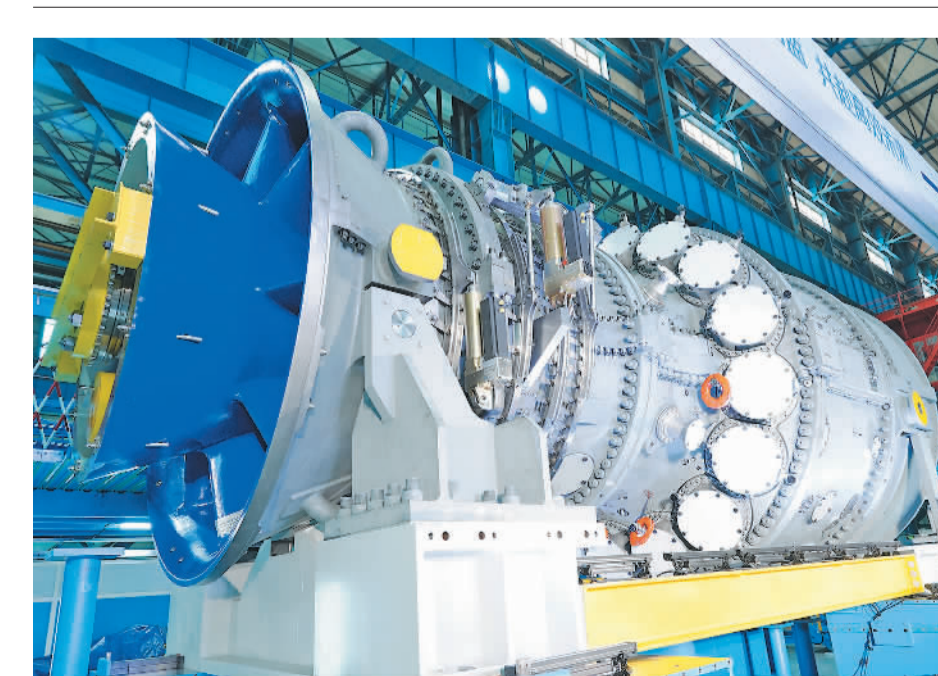
近日,首台国产HA级重型燃机在河北秦皇岛经济技术开发区哈电通用燃气轮机(秦皇岛)有限公司完工下线。该机械核心部件全部实现国产化,可通过天然气掺氢有效提高天然气燃烧效率,降低碳排放。王继军摄(中经视觉)
