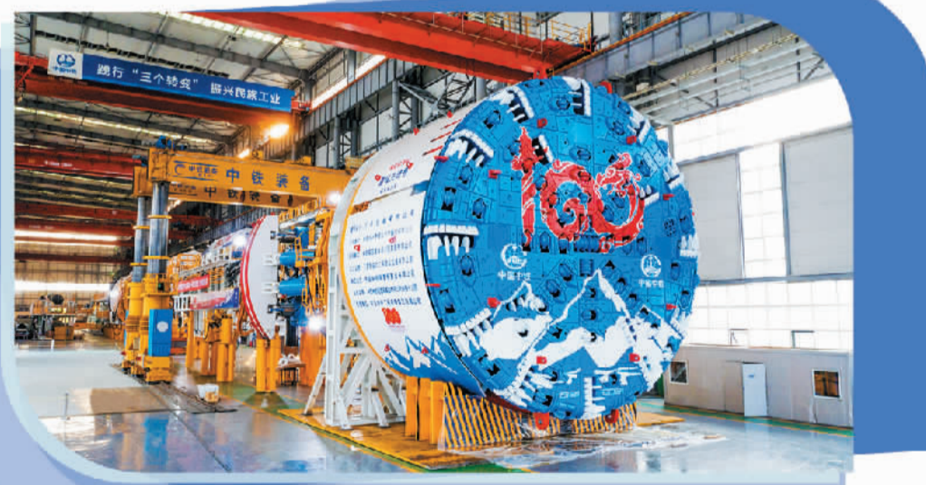
中铁装备研发的双结构硬岩掘进机。(资料图片)
