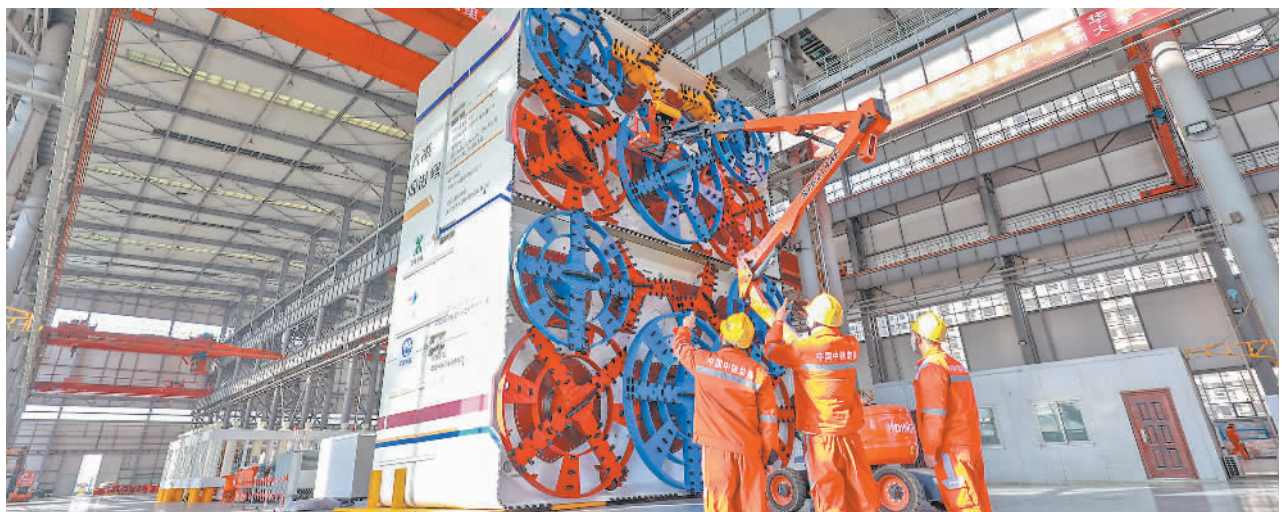
1月6日,在河南郑州中铁工程装备集团有限公司国家产业化TBM中心车间内,工人正在调试“中铁1179号”矩形顶管机。该设备为世界最大断面组合式矩形盾构顶管机,于当日正式下线,将用于深圳地铁12号线沙三站地铁站的建设,对促进地铁车站建设工法创新有重要意义。郝路平摄(中经视觉)
