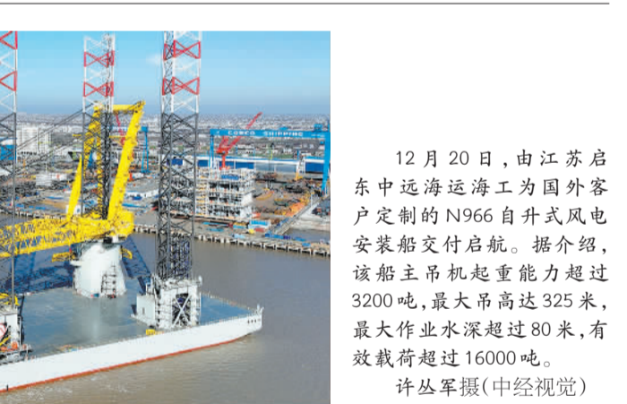
12月20日,由江苏启东中远海运海工为国外客户定制的N966自升式风电安装船交付启航。据介绍,该船主吊机起重能力超过3200吨,最大吊高达325米,最大作业水深超过80米,有效载荷超过16000吨。 许丛军摄(中经视觉)
