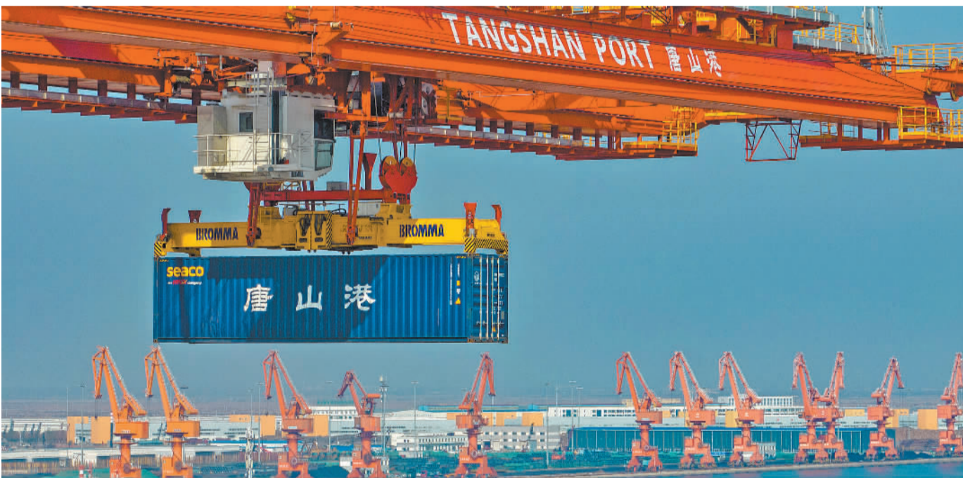
11月16日,新一代高效跨越式双小车岸桥在河北曹妃甸成功下线。该岸桥首创跨越式双小车系统,在传统单小车岸桥的基础上,增加了一部下小车,两部小车可同时交叉穿越作业,投入使用后,单机设备装卸效率提升50%以上,港口单泊位通过能力将达150万标箱。
