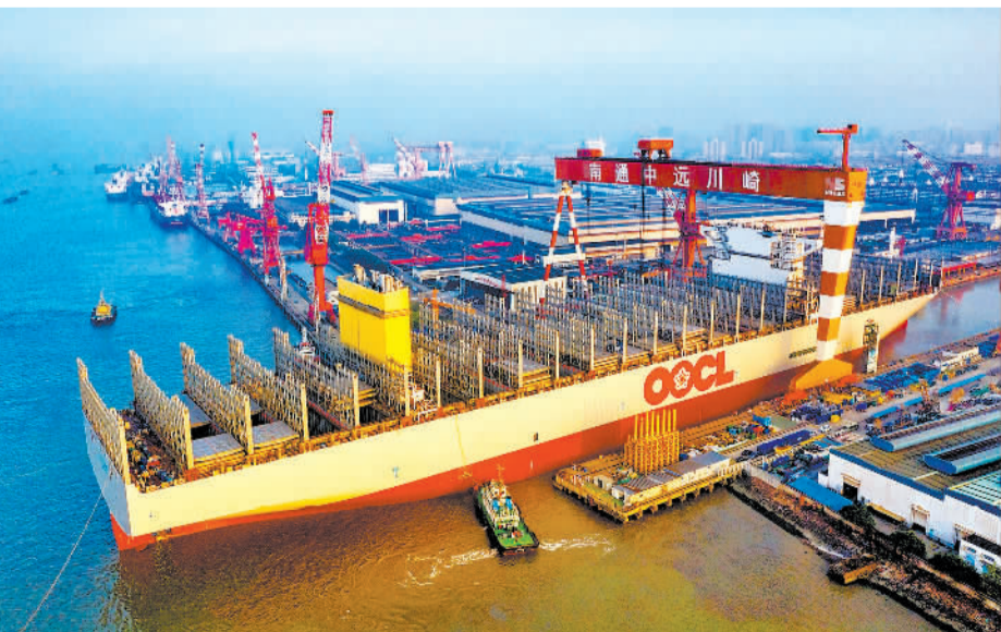
11月15日,一艘可装载2.4万个标准集装箱的超大型船舶在江苏南通中远海运川崎船舶工程有限公司顺利下水。该船为南通中远海运川崎系列订单中的首制船,船长399.99米,型宽61.3米,甲板面积相当于3.5个标准足球场,为目前全球尺度最大、箱位最多的集装箱船之一。 许丛军摄(中经视觉)
