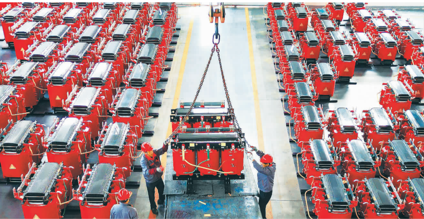
11月9日,江苏海安高新区的瑞恩电气股份有限公司,员工正在吊运变压器准备发货。近年来,当地推动制造业企业实施数字化改造,加快机器换人、生产换线、设备换新、产品换代,为企业高质量发展添活力、增效益。 顾华夏摄(中经视觉)
