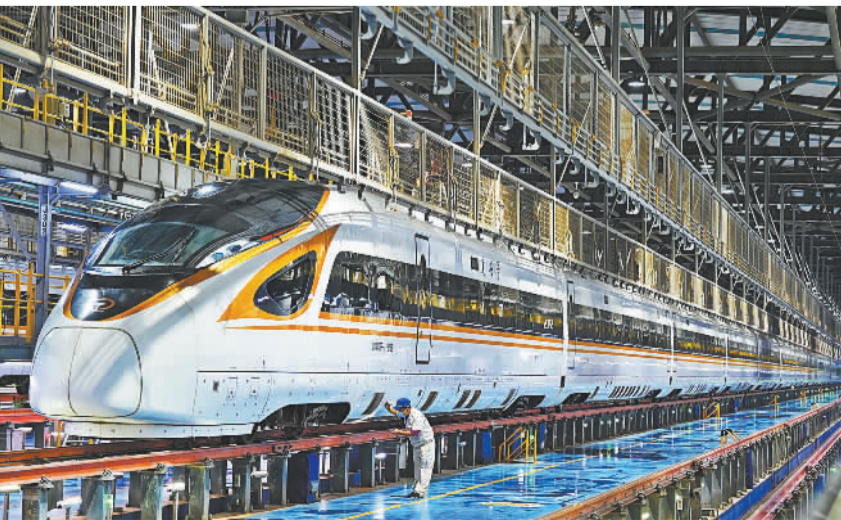
9月1日凌晨，郑州动车所检修库内，机械师在对复兴号动车组列车进行走行部设备检查。暑运期间，中国铁路郑州局集团有限公司发挥河南高铁成网优势，加大动车组列车开行密度，62天累计上线动车组列车6372标准组。王 玮摄(中经视觉)
