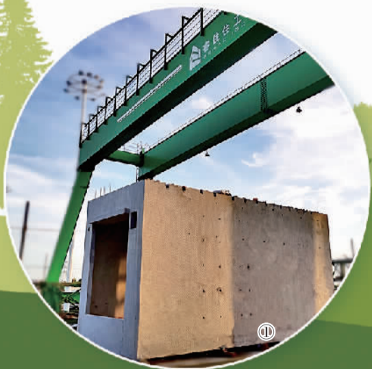
图① 广东睿住住工佛山工厂研发的集成模块化建筑产品。张建军摄 图② 佛山睿住住工零碳技术应用案例——宁波零碳生活体验馆。(资料图片) 图③ 佛山市顺德区美的云悦江山小区。张建军摄
