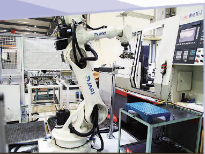
重庆江红机械公司生产车间内,机械手正在进行加工零件上下料操作。 本报记者 吴陆牧摄
