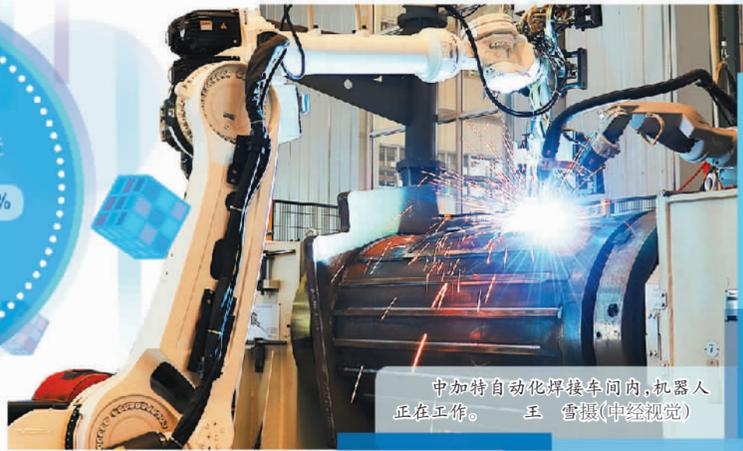
的员工史黎黎说,“之前加工72个线圈,需要3个人默契配合干一整天。车间引进全自动机器人后,我只需站在屏幕前操作设备,工序简单多了,但工作效率却提高6倍至8倍,不良品率也从过去近20%降到1%以下”。
