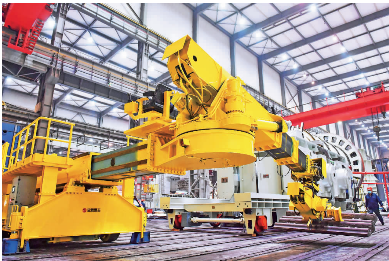
3月16日，特大型高端矿山装备GM220-180高压辊磨机、CSM-2250立式搅拌磨等在河南洛阳中信重工装备车间工厂试车并交付客户，突破了该领域装备关键技术。图为磨机衬板机械手。李卫超摄(中经视觉)
