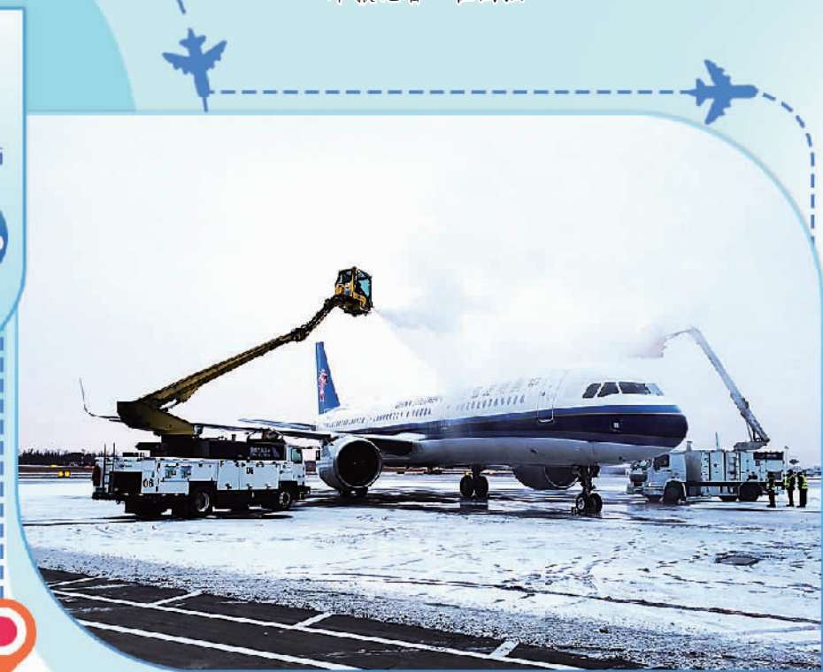
在长春市龙嘉机场，南方航空吉林分公司职工进行飞机除冰作业。（新华社发）
