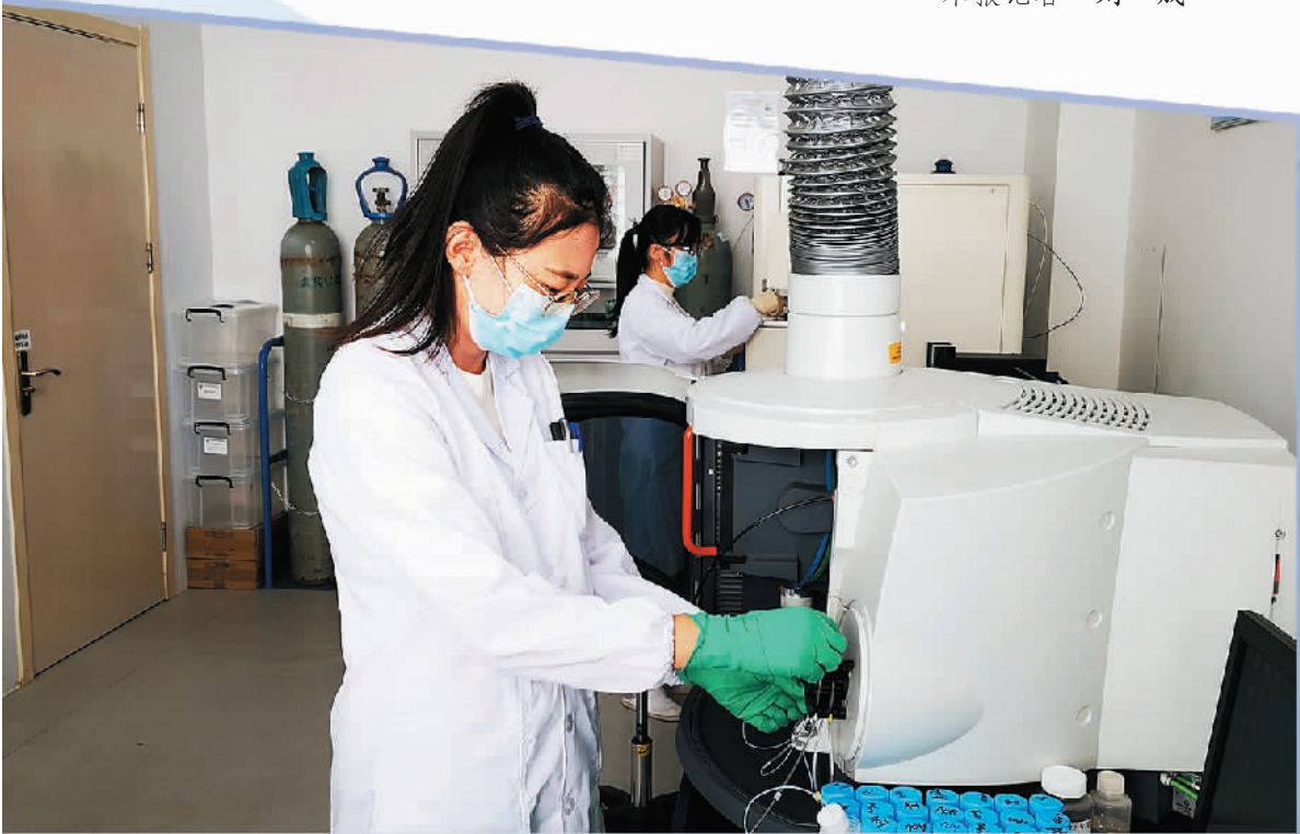
瓷兴技术人员正在测试氮化硅粉体品质。
