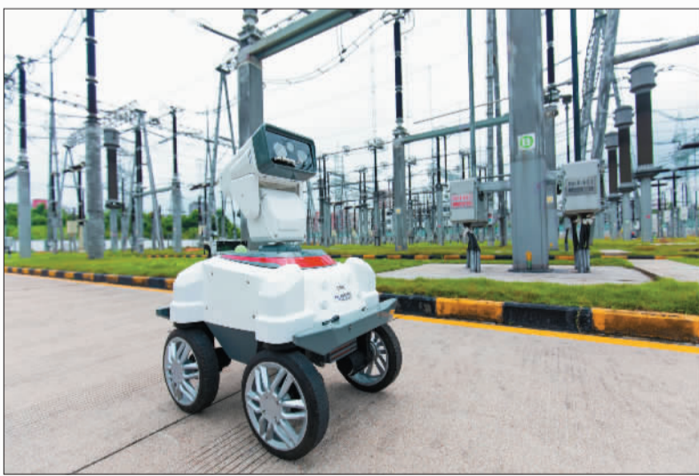
深圳供电局以新技术应用推动生产组织模式变革，提高全要素生产率。图为5G巡检机器人在变电站“巡逻”。
