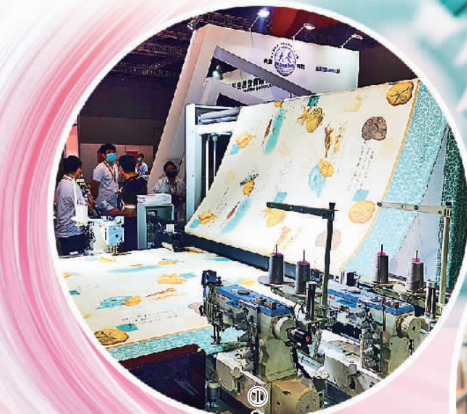
图① 在家纺展上，中缝利华智能技术有限公司展出的全自动电脑家纺双侧边自动流水生产系统，可高效率、自动化缝制布料双侧边，适用于家纺窗帘、浴帘、桌布等。
