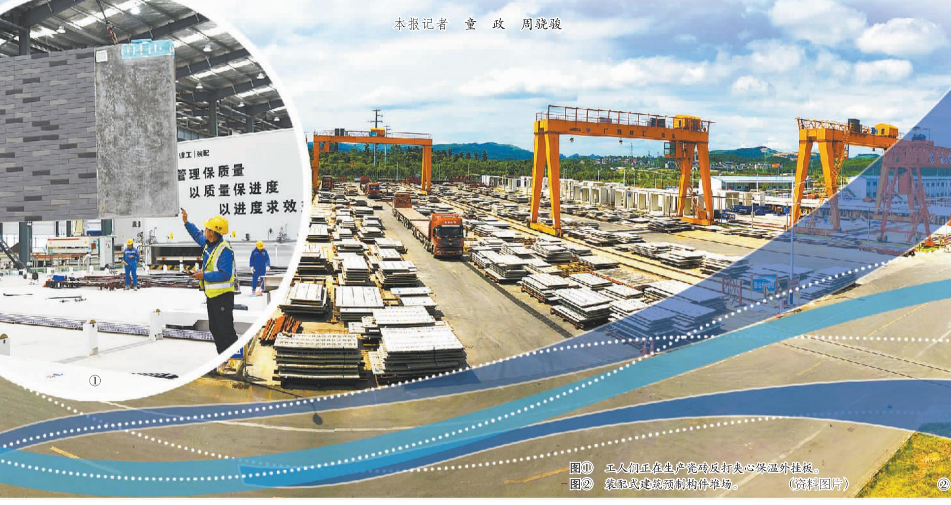
图① 工人们正在生产瓷砖反打夹心保温外挂板。
