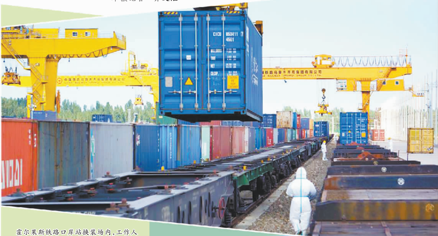
霍尔果斯铁路口岸站换装场内,工作人员为中欧班列开展换装作业。 邱 静摄
