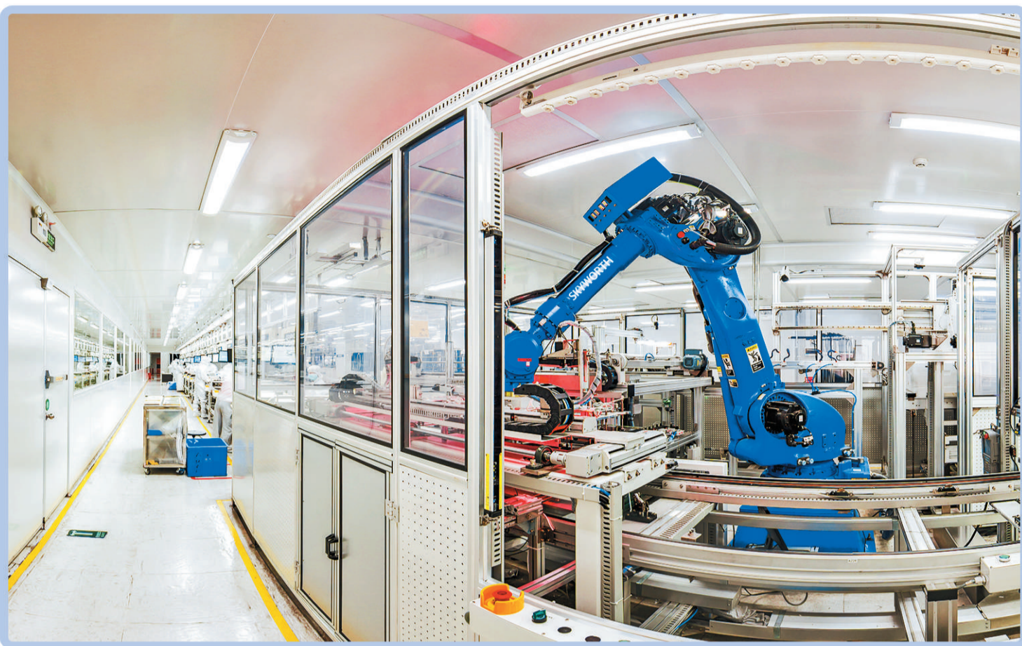
在创维深圳工厂电视生产线上,高精度视觉模组贴合设备正在有序工作。该设备在8K视觉、人工智能、5G云边协同等技术的支持下,采用全自动高精度机械手臂,与车间眼机器视觉完成模组玻璃撕膜及玻璃卡合工作。(资料图片)
