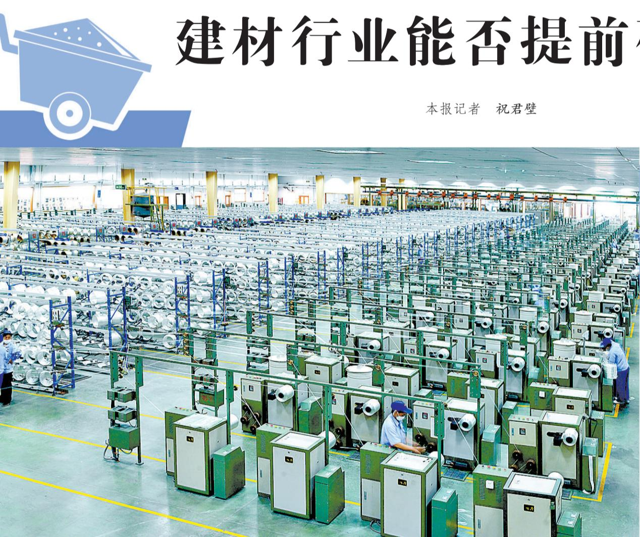
在中国巨石股份有限公司玻璃纤维生产熔纺车间，工人正在精心操作。作为生产玻璃纤维的主要工艺，池窑法具有生产规模大、效率高、能耗低、产品质量好等优点。（资料图片）
