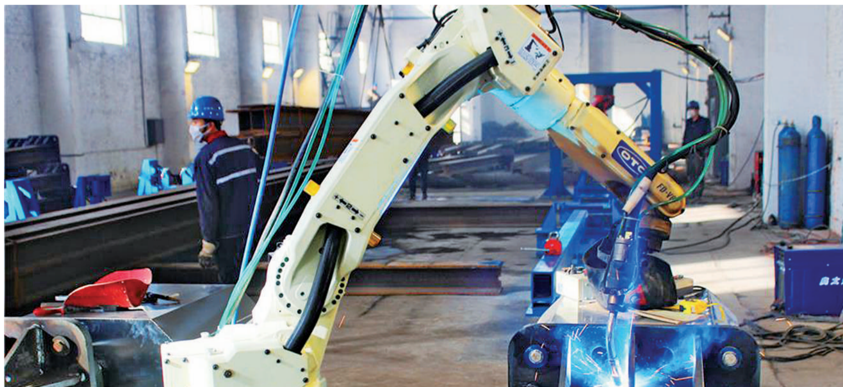
中国中铁电气化局工业公司保定制品公司生产车间里,机器人自动焊接接触网支柱。6月15日,首批由中国发往雅万高铁的接触网支柱抵达印度尼西亚西爪哇省万隆市的雅万高铁施工现场,标志着雅万高铁即将全面进入接触网施工建设阶段。 杨宏旭摄(中经视觉)
