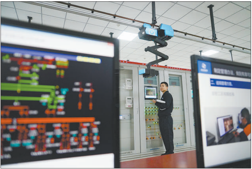
▲智能巡检机器人在京雄城际固安东无人值守变电所巡检。该机器人为变电所实现智能化运行、无人化值守提供强有力的技术支撑。
