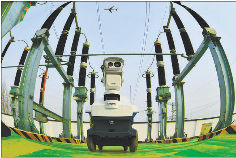
▲智能巡检机器人在京雄城际固安东无人值守变电所巡检。该机器人为变电所实现智能化运行、无人化值守提供强有力的技术支撑。
