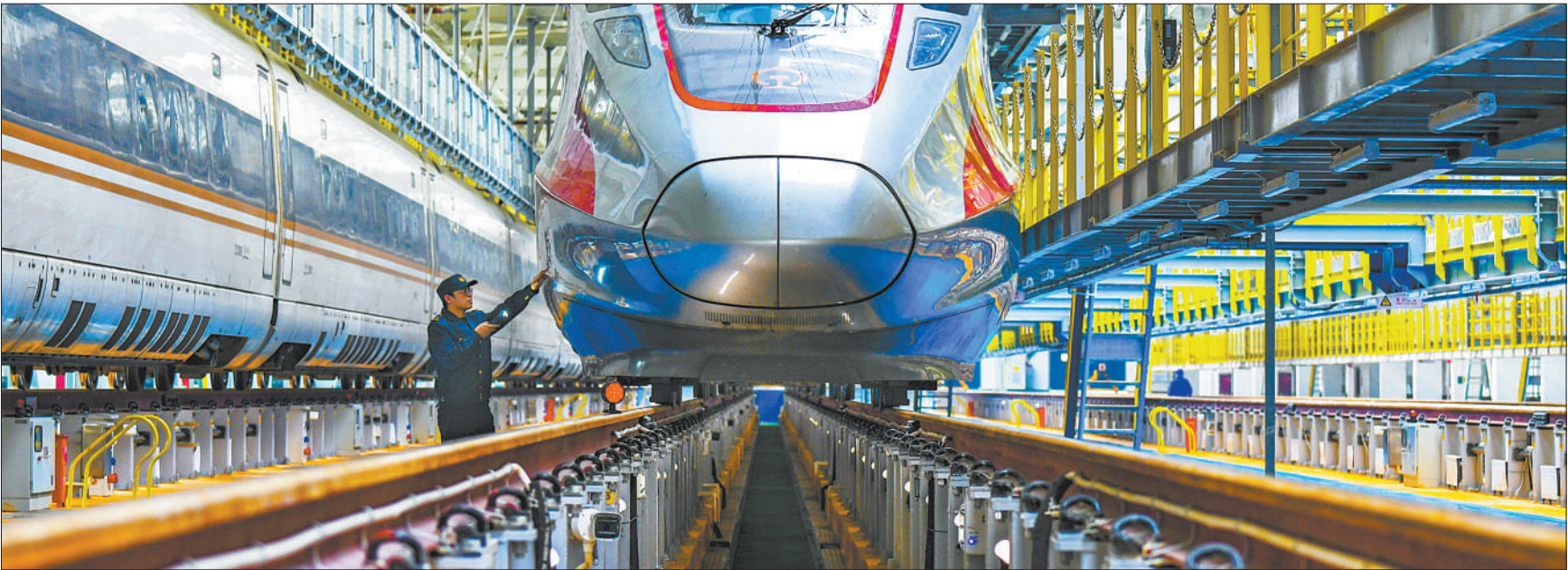
▼京雄城际雄安动车所工作人员用数字化巡检手电筒对动车设备进行检查。数字化巡检手电筒具有照明、录像、拍照等功能,能够记录作业过程,对于后续作业质量分析、作业者素质评价有重要参考意义。
