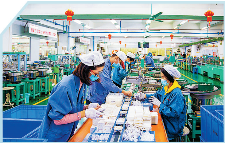
在格兰仕生产车间,工人们正在生产微波炉定时器。
