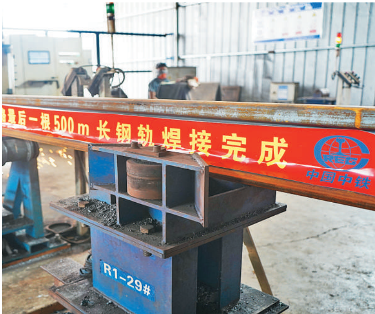
中老铁路万象焊轨厂最后一根500米长轨焊接完成。 张玉泉摄
