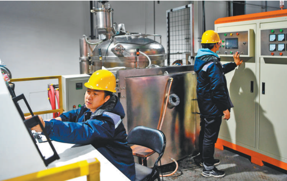
石嘴山先进材料协同创新中心工程中心,工作人员正操作送粉式3D打印设备熔钛合金金属粉末,以制作金属零件。
