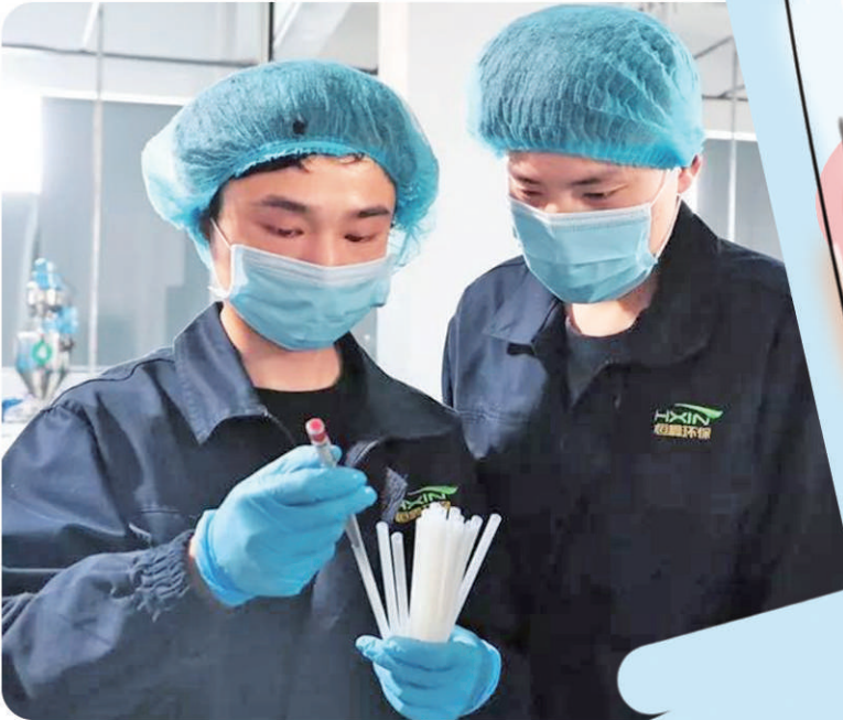
上图 恒鑫环保科技有限公司生产人员用口径规测量吸管内径,确保产品标准满足客户需求。 王春燕摄
