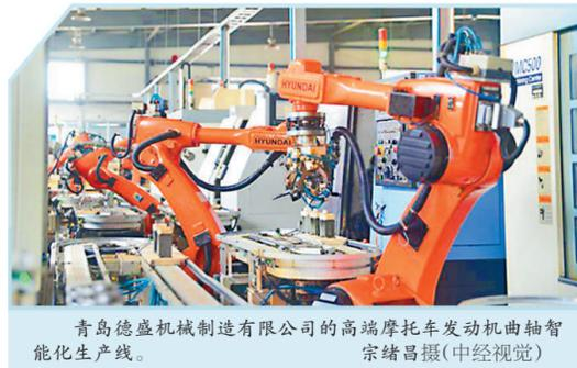
青岛德盛机械制造有限公司的高端摩托车发动机曲轴智能化生产线。 宗崇昌摄(中经视觉)
