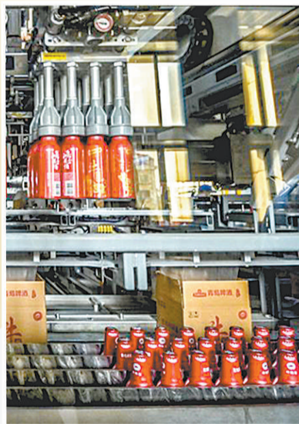
上图 青岛啤酒厂智能生产线机械手臂。 下图 青岛啤酒“灯塔工厂”智能化生产线。 王 伟摄(中经视觉)
