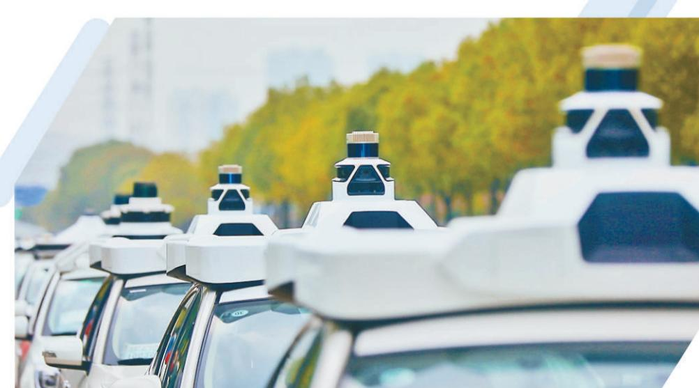
每辆东风RoboTaxi车顶都配有一顶“帽子”，这是该车自动驾驶的核心装置，配备了3个激光雷达、8个摄像头和1套时间同步处理器，具备先进的感知和AI决策系统。（企业供图）
