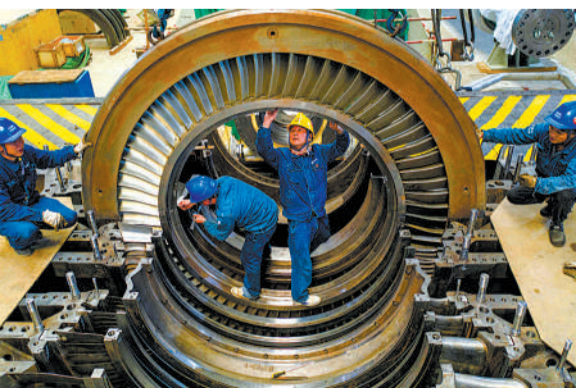
2月18日,国家能源集团湖南永州电厂项目员工正在作业。该电厂是湖南第一台百万千瓦发电机组,也是世界纬度最低的“烟塔合一”项目,计划于2021年9月底投产运营。 严洁摄(中经视觉)
