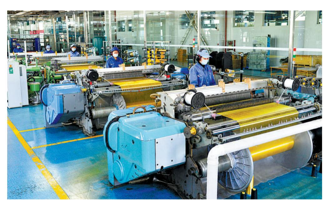
F-12纤维属于高性能芳纶纤维,制造出的布匹和绳子具有强度高、弹性好、重量轻、耐高温、耐酸碱的特点,是航空航天、机电、建筑、体育用品的基础材料,其生产技术由中国航天科工集团第六研究院自主研发,目前已实现产业化。
