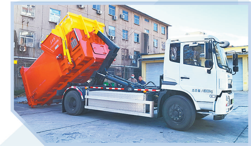
“东方红”牌18吨纯电动车载可卸式移动压缩中转站在安钢集团公司作业。倪 虹摄（中经视觉）
