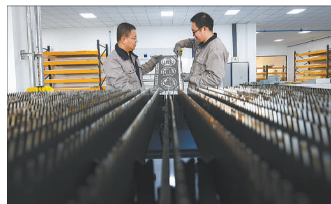
▼位于烟台国际设计小镇的山东省工业设计研究院数字化原型创新实验室，技术人员在做激光切割不锈钢样品板材加工。近年来，烟台紧紧围绕工业设计助力制造业转型升级，提高产品附加值。
