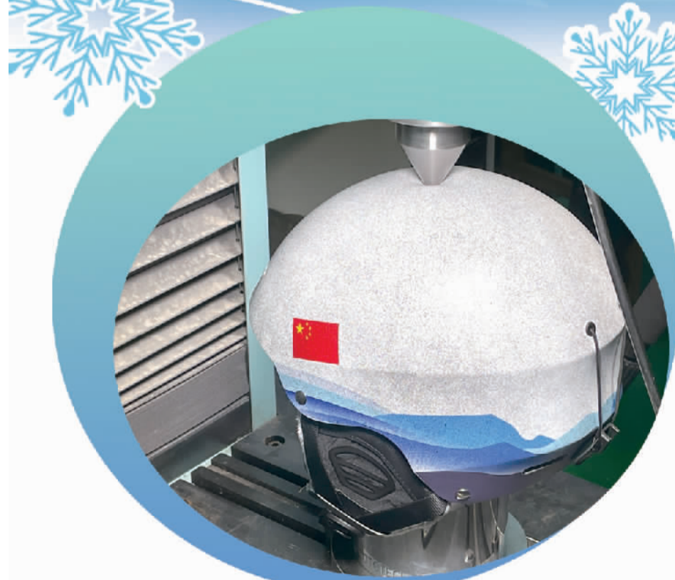
大连理工大学团队运用长征五号运载火箭外壳设计技术研发的头盔,已通过欧洲滑雪头盔安全标准测试,重量只有700克。本报记者 苏大鹏摄
