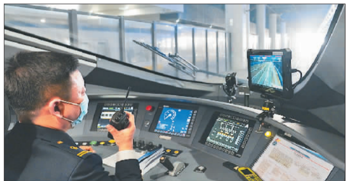
▼2022年1月6日,北京冬奥列车司机通过对讲机和列车长沟通信息。京张高铁在世界上首次实现时速350公里自动驾驶,具备车站自动发车、区间自动运行、到站自动停车、车门自动控制等功能。
