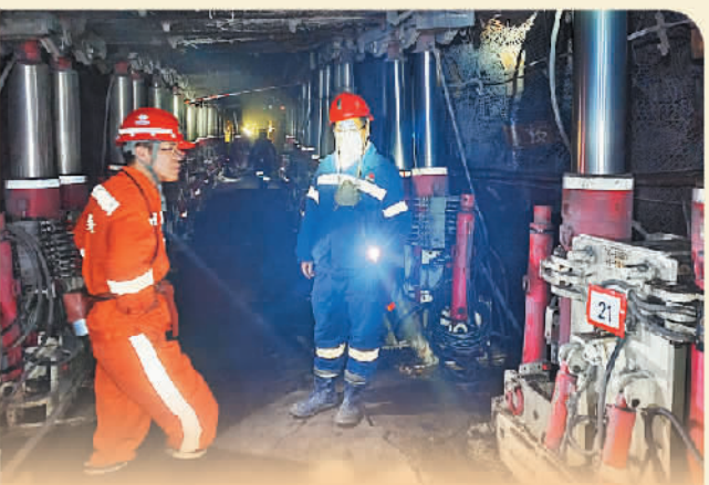
枣泉煤矿井下的智能化设施实现井下煤炭采运系统的无人值守、有人巡视的管理常态。 刘 颖摄(中经视觉)
