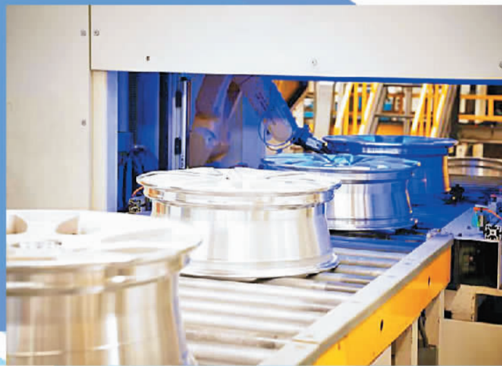
上图 中信戴卡铝车轮六号工厂自动化生产线上,机器人对产品进行自动插橡胶圈操作。
