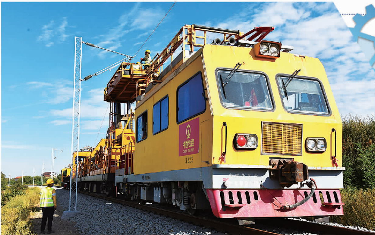
中国铁建电气化局建设者在匈塞项目新贝尔格莱德站使用接触网轨道车进行施工作业。 郭 栋 摄
