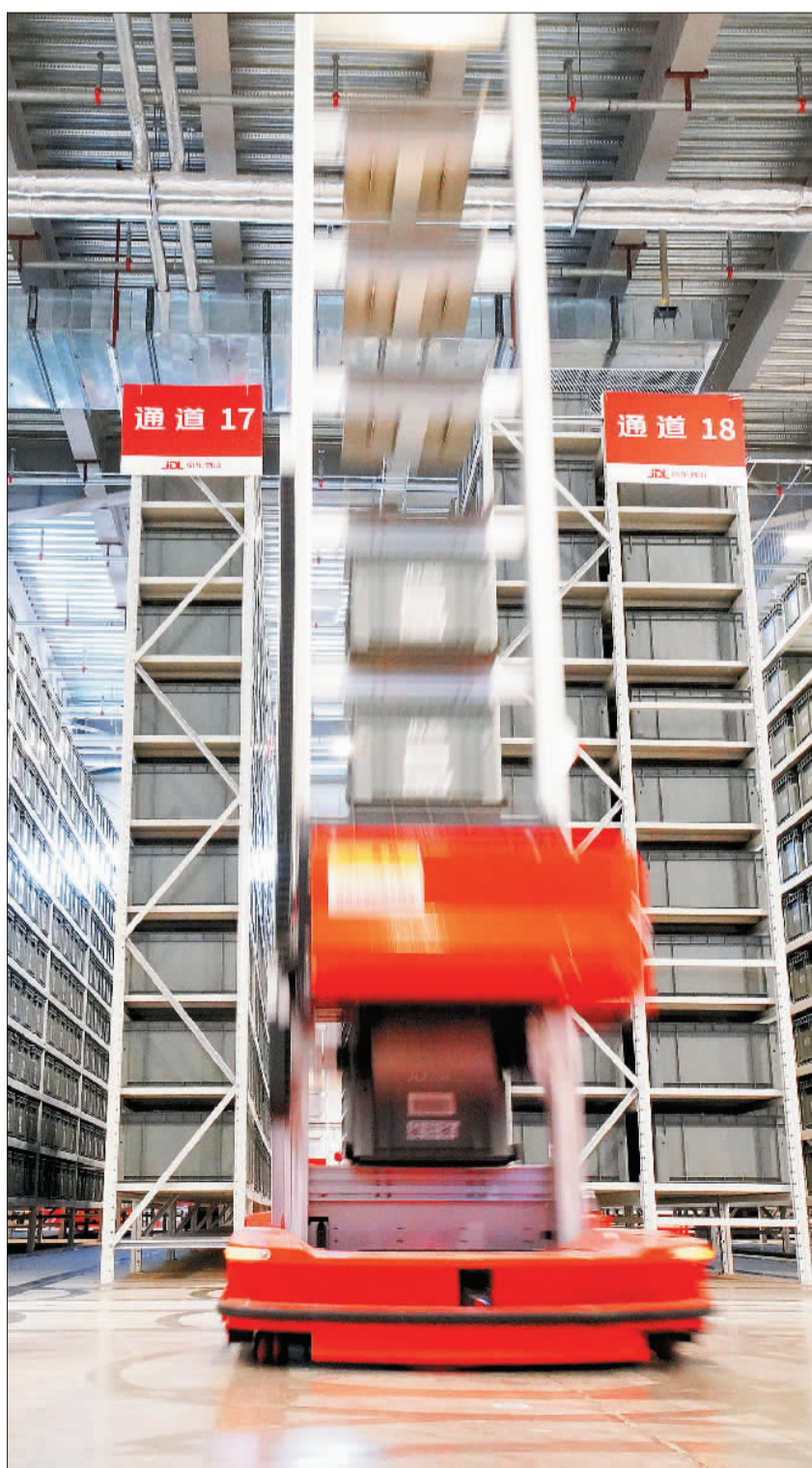
▲京东物流北京“亚洲一号”智能物流园区内拣选机器人在工作中。近年来，京东凭借大数据、云计算等技术优势，着力布局智能物流产业基地。通过应用智能仓储和分拣设备、智能大脑，实现软件、硬件、员工作业一体化协同。
