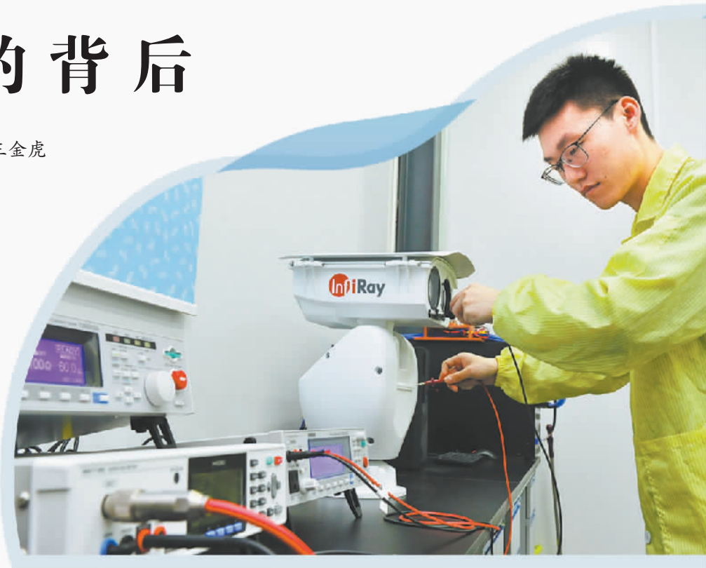
公司研发人员正在调试8微米全高清热成像云台。
