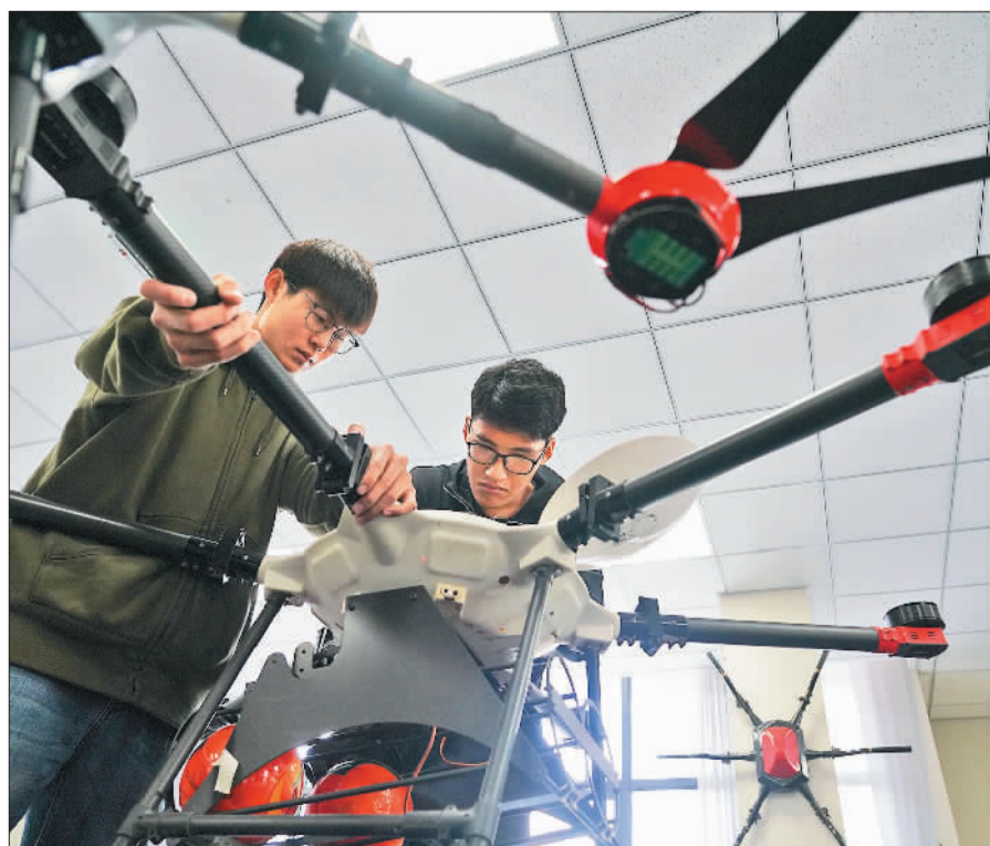
▼安徽梧桐航空科技有限公司，员工正在组装六旋翼植保无人机。该公司主要从事无人机产品研发，目前拥有52项专利。
