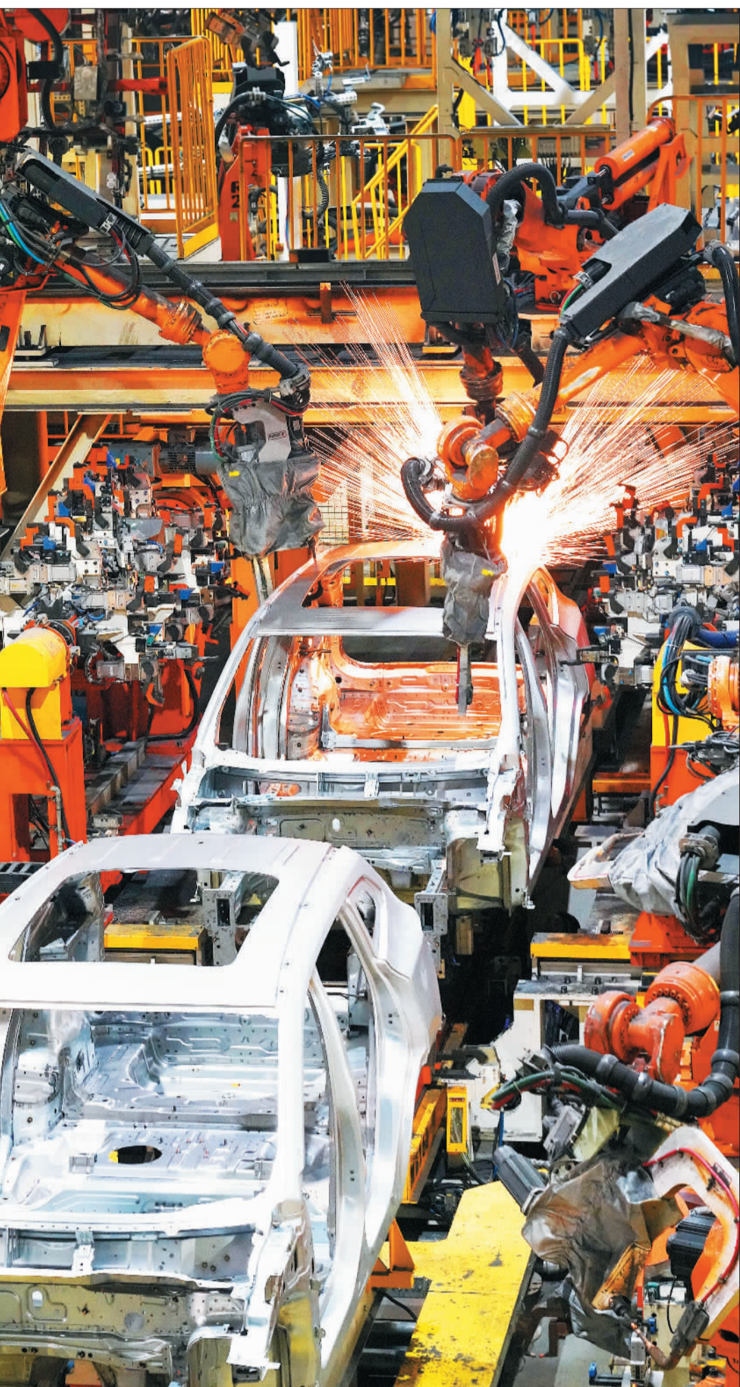
▲芜湖市奇瑞汽车焊装三车间机器人正在焊接操作中。该品牌汽车拥有国内首条全国产自动化点焊装配线。
