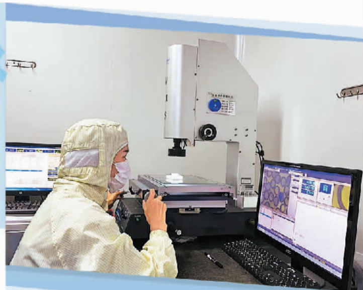
成都欧赛医疗器械有限公司生产车间内，一位员工正在测量丝束内径。杨梅摄(中经视觉)
