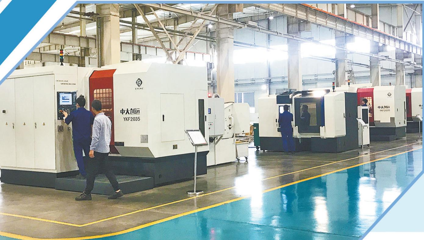
在中大创远装配车间内，工人正在调试机床。
