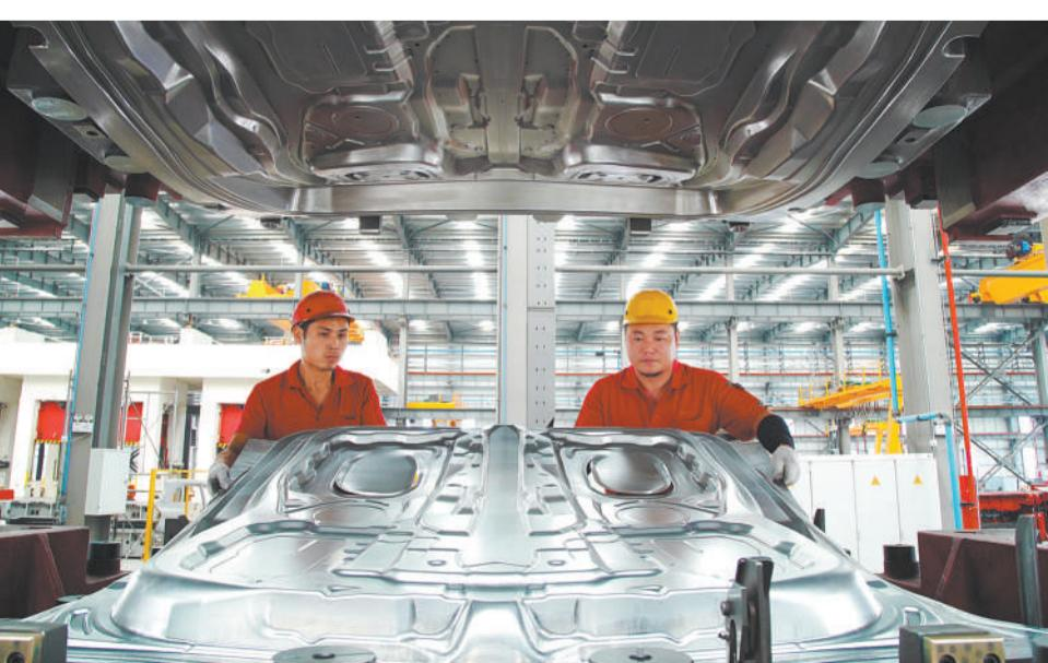
浙江宏旭智能制造有限公司位于浙江湖州市南浔经济开发区，是国内一线汽车品牌模具主力供应商。今年以来，公司调整生产结构，推进智能化、数字化生产车间建设，提高产品质量，提升企业竞争力。图为该公司工人正加紧赶制发往国际市场的汽车车身外覆盖冲压件模具。
