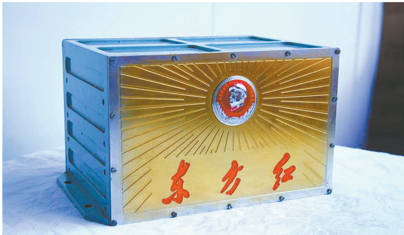
1970年4月24日,我国用“长征一号”运载火箭成功发射第一颗人造卫星“东方红一号”。图为“东方红一号”卫星的音乐装置。(资料照片)
