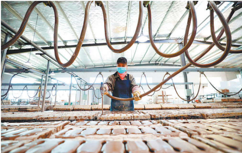
1月29日,位于江西省黎川县的江西省康舒陶瓷有限公司员工在进行注把作业。近年来,黎川县依托中国日用耐陶瓷产业基地优势,设立产业发展基金,在陶瓷企业科技创新、人才培养、节能减排等方面给予大力支持,加快传统产业转型升级。王式辉摄(中经视觉)
