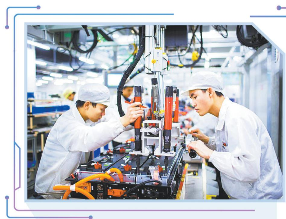
宁德时代一线员工正在使用自动拧紧系统固定电池模组。
