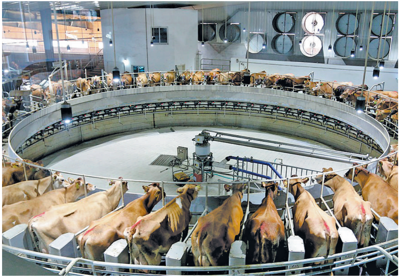
图为辉山乳业牧场内的转盘式挤乳设备。
