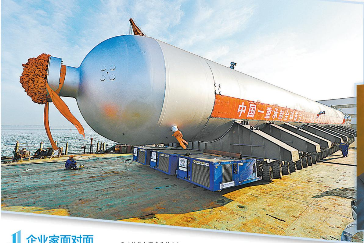
左图 中国一重集团有限公司生产的全球首台3000吨浆态床锻焊加氢反应器。
