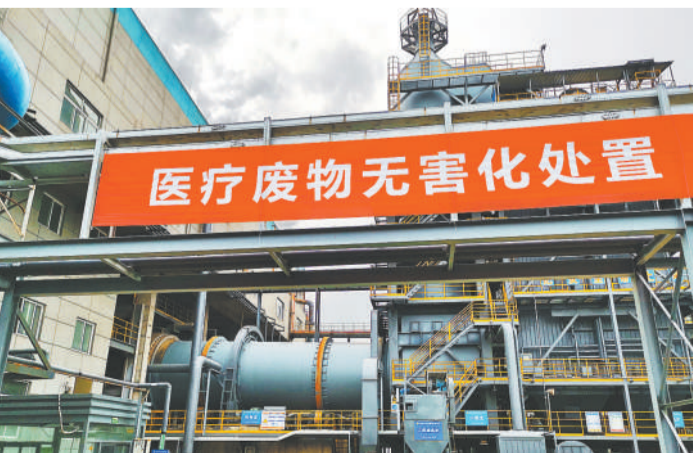
湖北中油优艺环保科技有限公司采用回转窑焚烧处置技术处置危险废物,日处置能力30吨至40吨。
