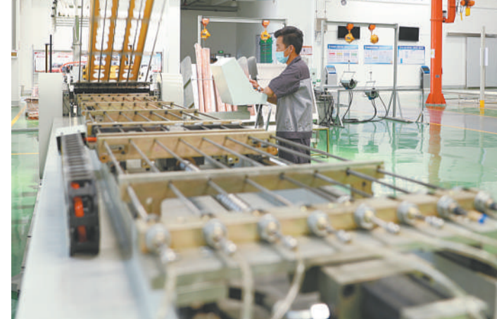
在国家级霍尔果斯经济开发区兵团分区新疆昆晟同方人工环境有限公司内,工人们正在组装空气源热泵。
